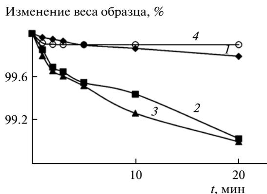
**Рис. 7.** Изменение веса образцов под воздействием ультразвука. Покрытия сформированы: 1 – в базовом электролите; 2 – в базовом электролите + 100 мл/л эмульсии; 3 – в базовом электролите + 100 мл/л эмульсии + 20 г/л порошка ПТФЭ; 4 – в базовом электролите + 100 мл/л эмульсии + 40 г/л порошка ПТФЭ.
